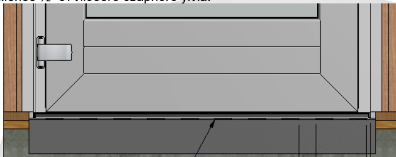
Рис. 6: Подкладки на пороговый косяк
