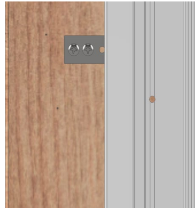
Рис. 10: Доступ к базовым отверстиям для крепления бокового косяка
