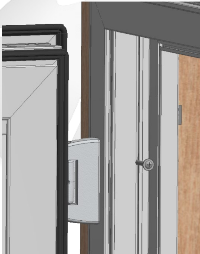
Рис. 11: Частично закрепленное предварительное крепление бокового косяка
