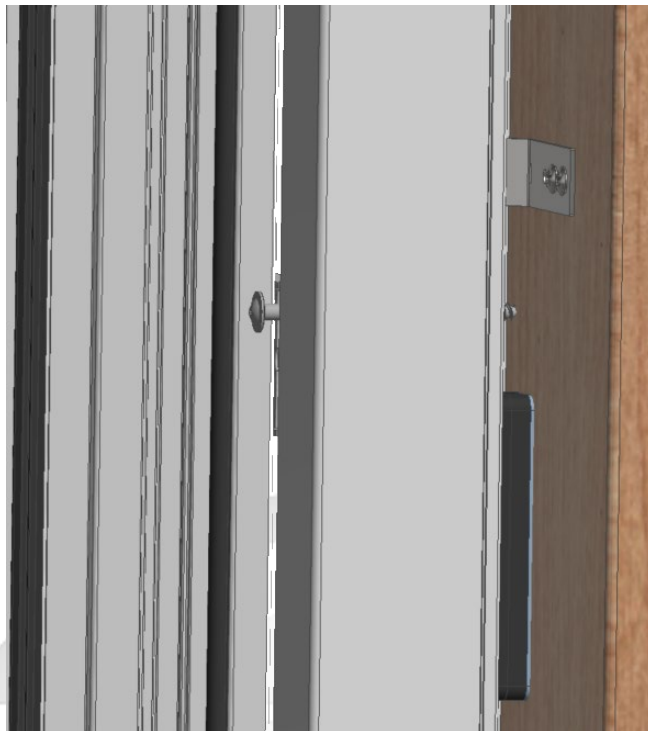
Рис. 12: Предварительное укрепление подкладками бокового косяка
