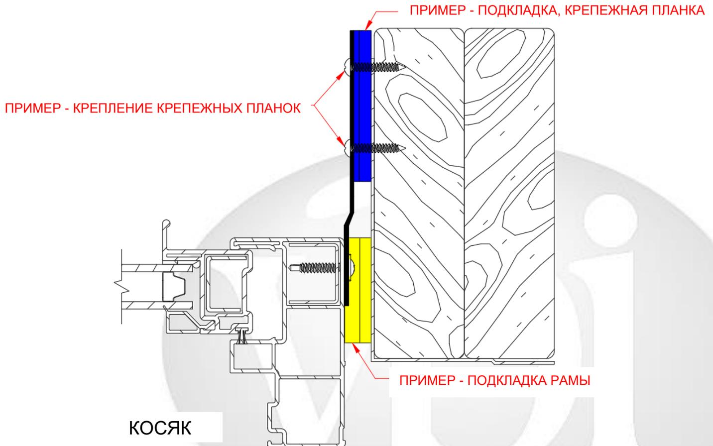
В) Для крепежного ребра – используйте специальные крепления.
