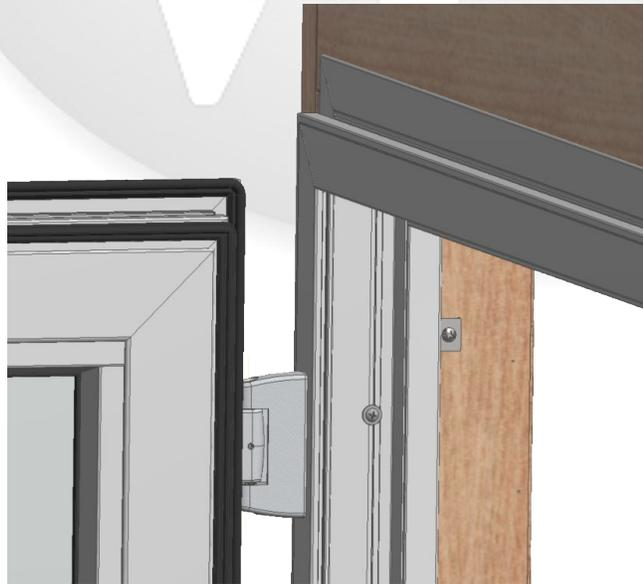
Figura 13: Sujetador preliminar de la jamba completamente calzado y ajustado
