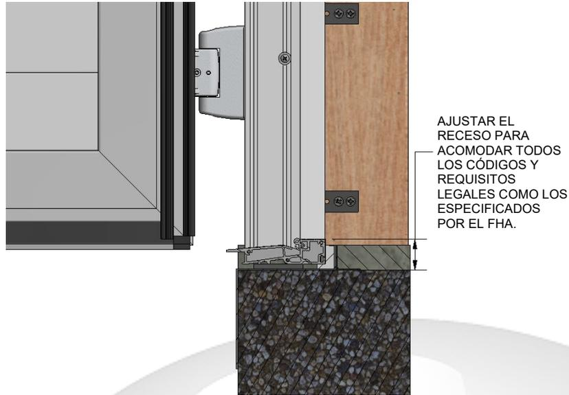
Figura 4: Separación de los cimientos de losa a nivel hasta el piso terminado
