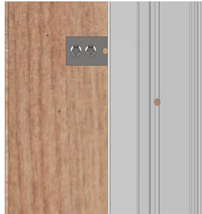
Figura 10: Agujeros piloto de fijación de la jamba revelados
