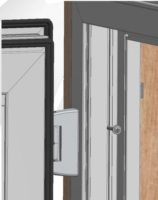
Figura 11: Sujetador preliminar de la jamba parcialmente sujetado
